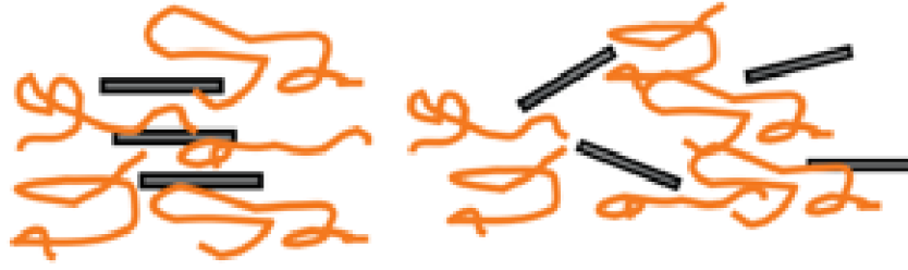
Figura 7.2 – (a) Nanocompósito intercalado e (b) com esfoliação completa.
