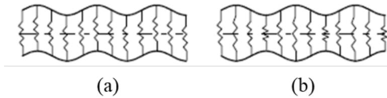
Figura 10.16 – Núcleo dividido em um conjunto de molas lineares, com a flambagem ocorrendo (a) de forma antissimétrica e (b) simétrica com relação à linha média.
