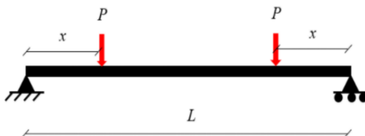
Figura 10.5 – Viga bi-apoiada sujeita a duas cargas pontuais P , onde uma delas se encontra a uma distância x do apoio esquerdo, e a outra a uma mesma distância x do apoio direito.
